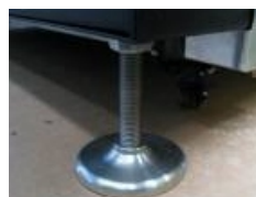
Pasaje de cables y pata soporte
